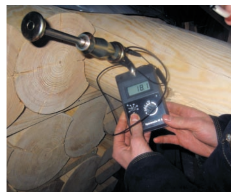
Diese gemessene Feuchtigkeit von 18,1% ist zulässig.
